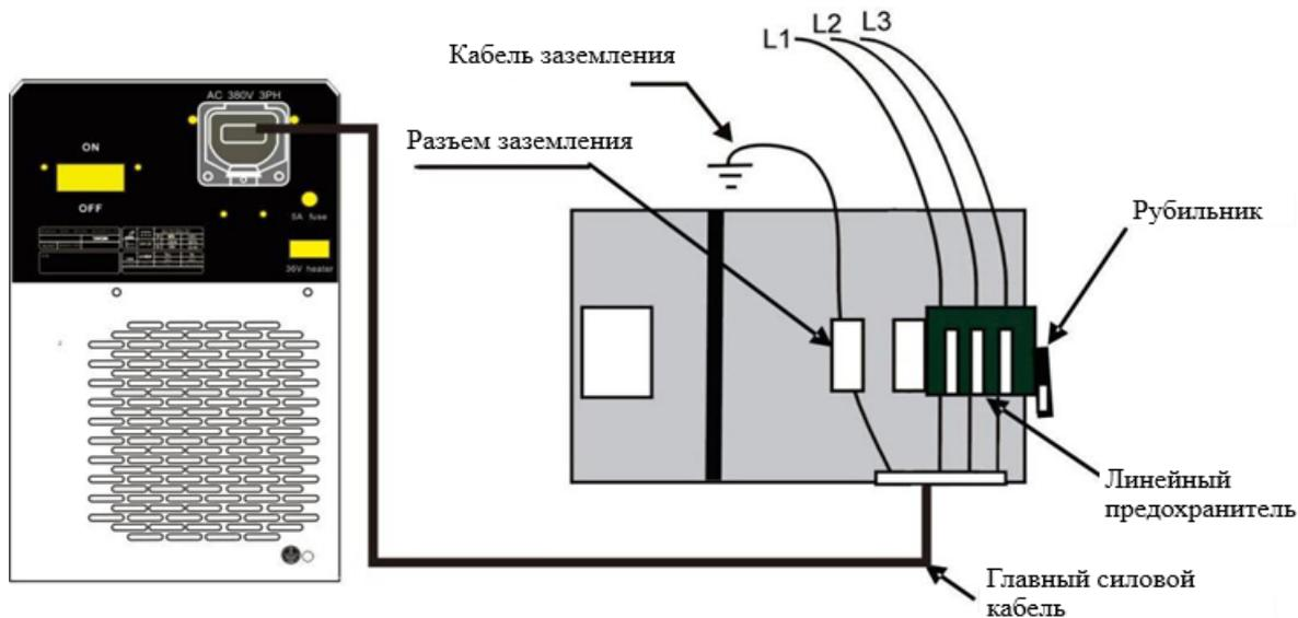
Подключение аппарата должно осуществляться в соответствии с Правилами устройства электроустановок и иными действующими на момент подключения нормативными актами уполномоченным лицом, имеющим соответствующую подтвержденную квалификацию и допуск.
